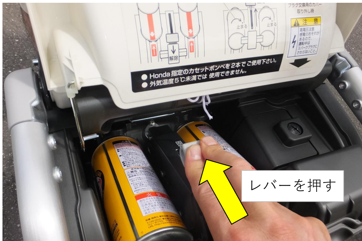
5. ボンベを2本装着し、レバーを固定の方向に押し込む
